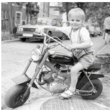
Jeden z prvních strojů měl od dědy, který použil motor z mopedu Stadion a svařil k němu rám
